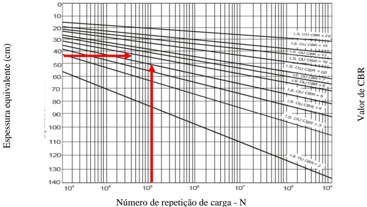
Determinadas às espessuras  $H_m$ ,  $H_n$ ,  $H_{20}$  pelo gráfico característico do método, e  $R$  pela tabela das espessuras mínimas da base ( $B$ ), sub-base ( $h_{20}$ ) e reforço do subleito ( $h_n$ ), são obtidas pela resolução sucessiva das seguintes inequações:
