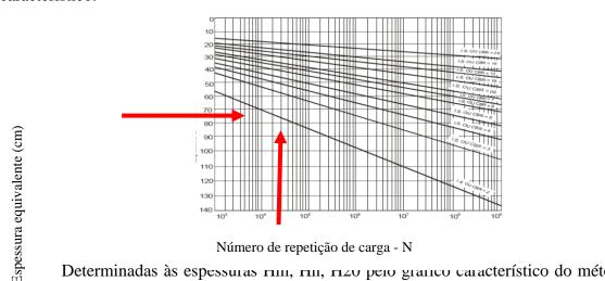
Determinadas às espessuras min, min, milo pero granco característico do método, e R pela tabela das espessuras mínimas da base (B), sub-base (h20) e reforço do subleito (hn), são obtidas pela resolução sucessiva das seguintes inequações:
