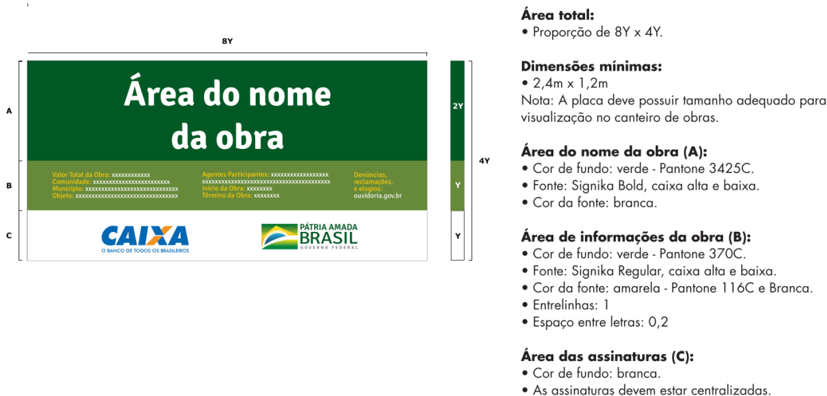
Figura 3 – Placa de obra padrão do Governo Federal
